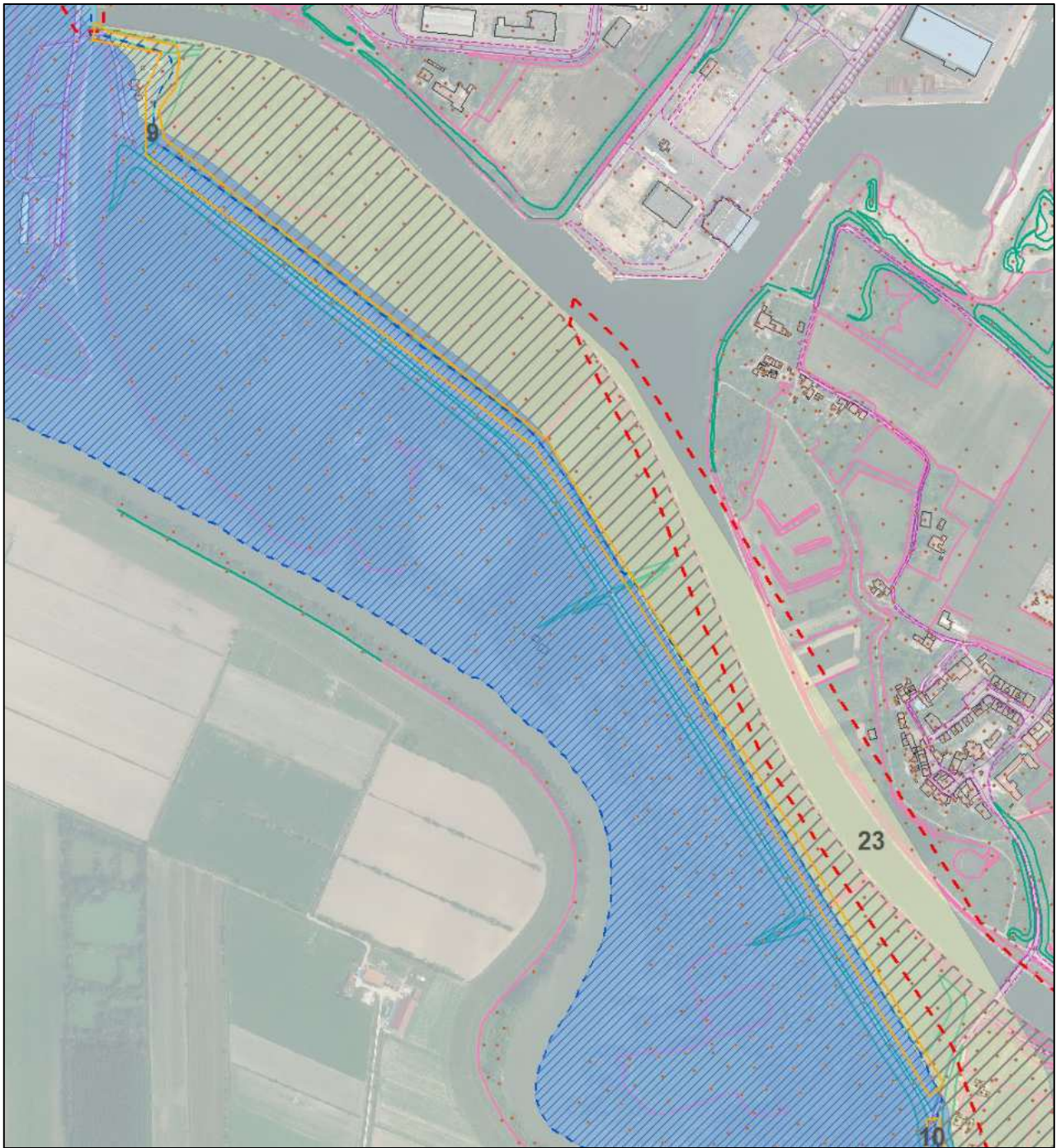
Punto 9: adeguamento fasce A-C alla scarpata dell'aerofotogrammetria
