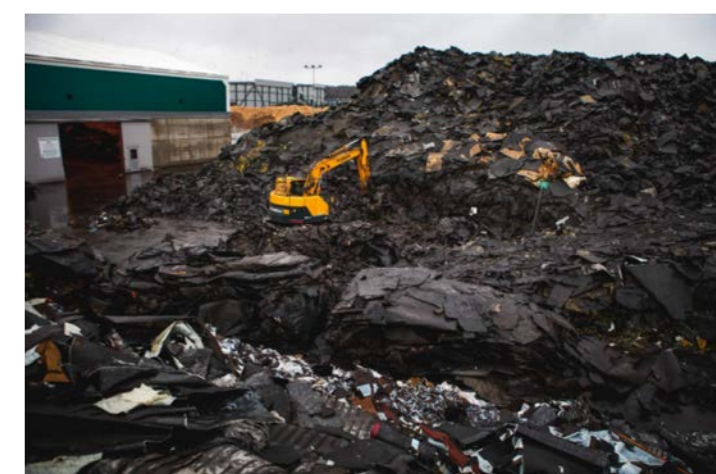
Trasformazione dei rifiuti di scaglie di coperture bituminose in asfalto a Kujala.
